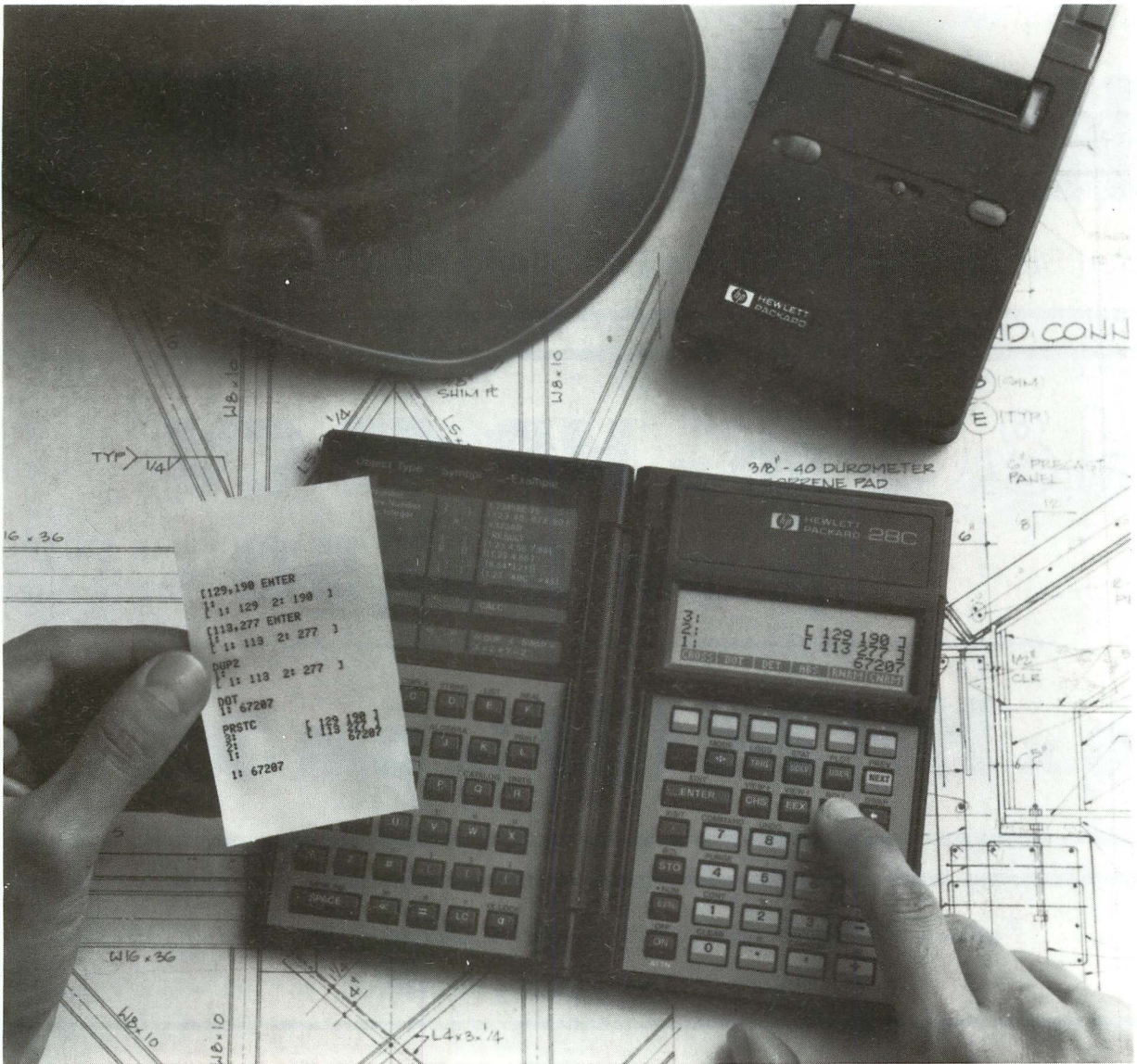
Der HP-28C steuert den Drucker HP 82240A über einen Infrarotstrahl an. Kein Kabelsalat mehr, keine Verbindung herzustellen. Einfach aufstellen, einschalten und los gehts.
